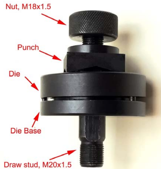
Figure 1. A punch & die set (Auber part #: pd-4545).
